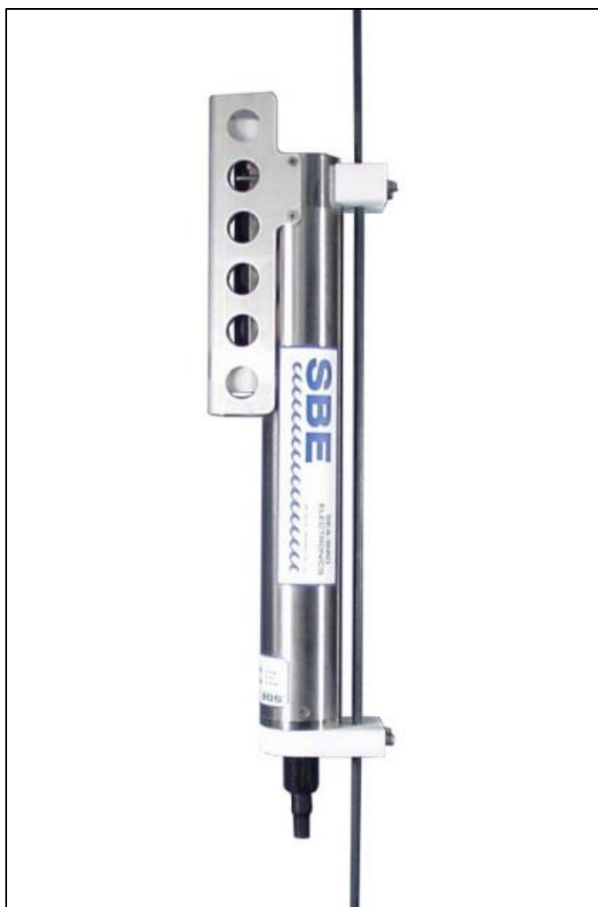
Figura 7. Equipo de calidad de agua SeaBird Sbe37 para monitoreo continuo.
